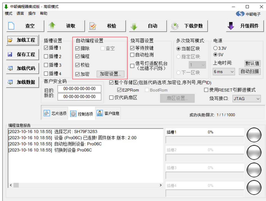
图 5.2.10.a 烧写示例_烧录步骤及代码加密配置
