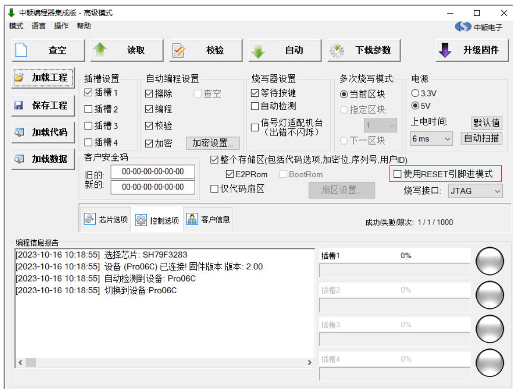
图 6.1.5.a 使用 ResetPin 进模式配置
