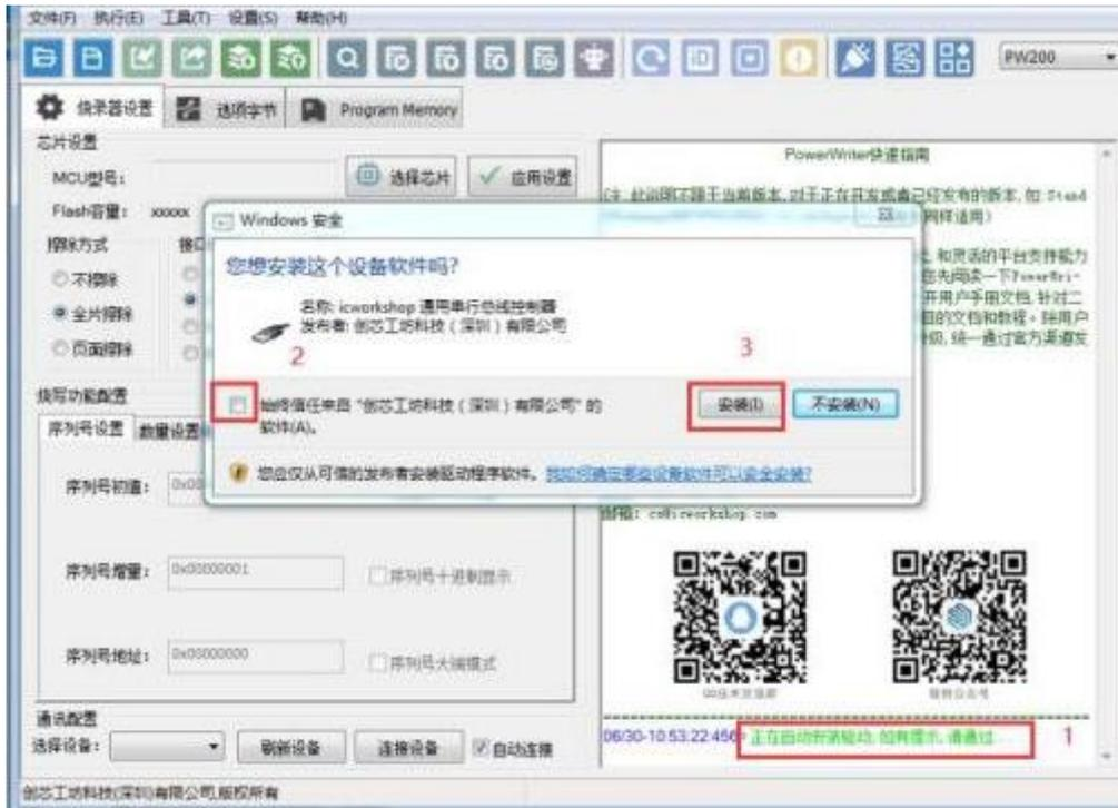
安装完成后，则会提示驱动安装成功，此时如果有连接 PowerWriter 硬件，客户端软件将 会自动连接上 PowerWriter ；
